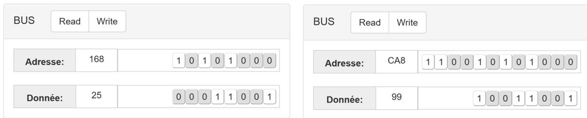
Figure 5 : Panneau de contrôle des bus d'adresses et de données. À gauche avec les valeurs en décimales et une mémoire de 256 octets. À droite avec les valeurs en hexadécimales et une mémoire est de 4096 octets.
